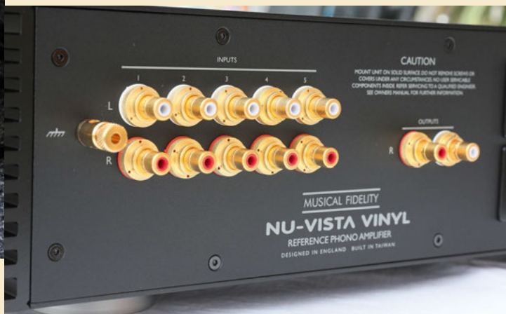
Eine einsame Erdungsbuchse muss für 5 Eingänge ausreichen
