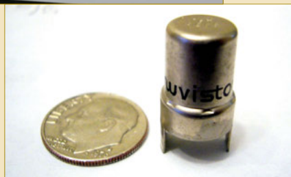
Als Verstärkerbauteile werden in der Eingangsstufe Nuvistoren eingesetzt. (Bild: Wikipedia)
