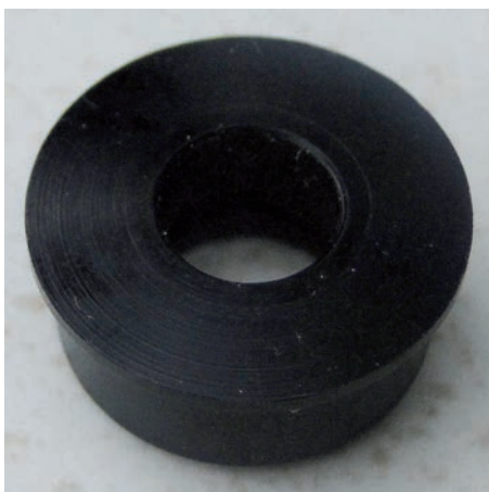
Bild 26: In dem kleinen Teil steckt also das «Geheimnis» dieser Arretierungsmethode. Die abgebildete «Zentrums-Erhöhung» ist die Normal-Version. Bei der Version für sehr dicke Platten ist die obere Wulst schwächer. Der untere Zylinder «verschwindet» im Kristall-Teller.
