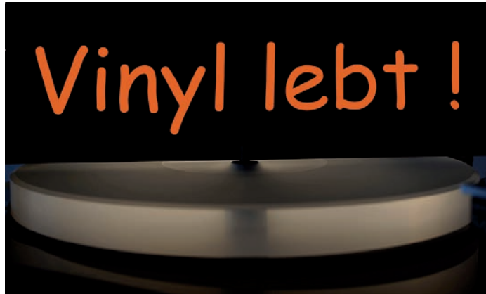
Bild 29: Die Vertiefung ist fast nicht sichtbar. Man erkennt aber, dass das Licht (für dieses Foto wurde eine Lampe hinter der Pappe «Vinyl-lebt» platziert), zum Zentrum des Tellers intensiver wird, da die Breite des Spalts zunimmt. Auch hier täuscht wieder die Label-Vertiefung. Das im Text angegebene Gefälle ist bis zum Rand derselben gerechnet. Foto: Radovan Tajder
