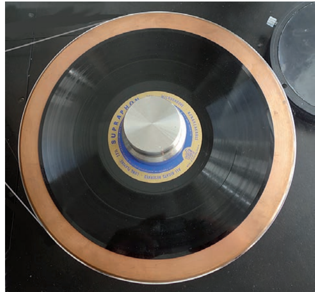
Bild 3: «Na, diese liegt ja wie ein Brett». 10-Inch-Platten haben bei gleicher Dicke gegenüber 12-Inch-Platten bezüglich der inneren Stabilität Vorteile. Hier auf dem Franke-RTS beim Autor, als LP-Matte dient eine Kupferplatte (2,3 kg schwer).
