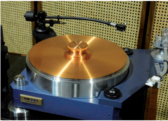
Bild 14: Ein Modell (SX 8000), speziell für die Platten-Arretierung mittels Ring, von der Firma Micro-Seiki. Man erkennt sehr gut den rechten Winkel von Teller-Oberseite und dem Aussenmantel des Tellers. Die schweren Micro-Seiki-Ringe «hängen» nicht (vielleicht bei sehr dicken LPs), sondern sitzen auf. Dazu ist der Teller speziell gefertigt. Foto: Mr. Henry Lee (Fa. Audio HK68)
