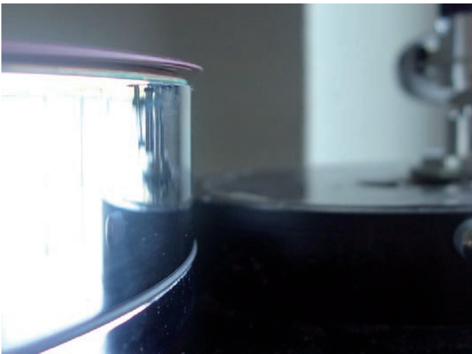
Bild 15: Bei modernen Masse-Laufwerken, wird bewusst der Tellerdurchmesser kleiner konzipiert, als der Plattendurchmesser (wie hier beim FRANKE-RTS des Autors), damit man die LP den Teller wechseln kann ohne anzuhalten. Damit ist eine Nachrüstung mit einem Klemmring ausgeschlossen.
