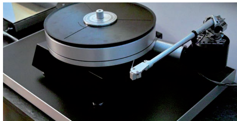
Bild 19: Die Ansaugmatte TRANSROTOR «POLYPUSH» auf dem grossen FRANKE-Laufwerk «RTS II». Man erkennt hier eine andere Strukturierung der Ansaugfläche. Die Luft wird mittels einer Handpumpe abgepumpt. Foto: Hans Appell
