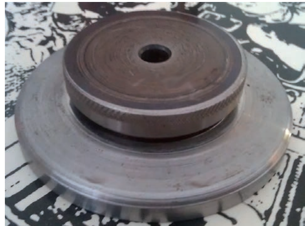
Bild 4: Das Versuchsmuster eines Plattengewichts, das später einmal in Bronze bzw. Messing hergestellt werden sollte. Auf Grund der schlechten Ergonomie dieses Teil blieb es bei einem Versuchsmuster. Der Praxistest wurde nach der ersten beschädigten Platte abgebrochen. (Foto: Thomas Droigk)
