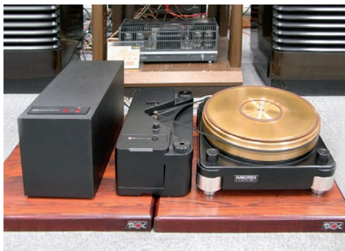
Bild 18: Micro-Seiki «RB-1500 u. RY-1500 u. RV-1090», hinter den einzelnen Modell-Bezeichnungen verbergen sich der Plattenspieler, die Motoreinheit und die Ansaugpumpe (auf dem Bild von rechts nach links). Man erkennt diese aufwändige Konstruktion. Die Silikonlippen kann man erkennen, die beiden Absauglöcher kann man auf Grund ihrer Kleinheit im Verhältnis zum Gesamtobjekt nur erahnen. Foto: Mr. Henry Lee (Fa. Audio HK-68)
