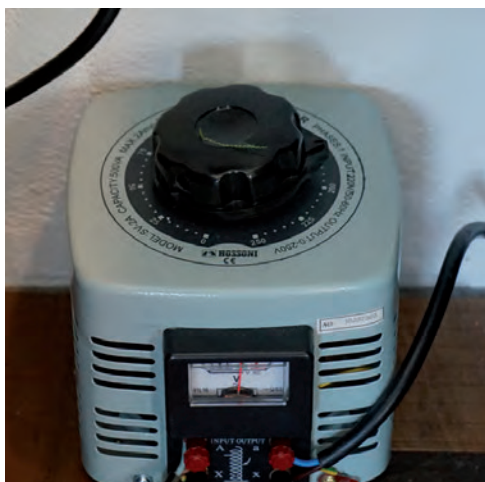
Stelltrafo für den Plattenspieler zur Reduktion der Stromspannung
