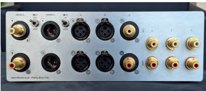
Eingänge Baby Reference Pre amplifier: 4 x RCA (Cinch), 2 x XLR (symmetrisch); Ausgänge: 1 x XLR, 1 x RCA (Je nach Kundenwunsch können Ein- und Ausgänge auch in anderer Zusammensetzung gewählt werden)
