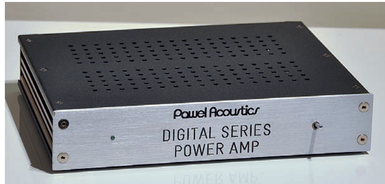
Hier eine 6 Kilo schwere 250 Watt Digitalendstufe aus dem Jahre 1984
