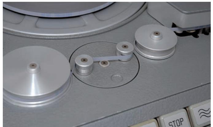
Nach Einlegen des Bandes wird die Bandzugwaage durch ein leichtes Strecken des Bandes in ihre Arbeitsposition gebracht. Dadurch wird der Capstan-Motor eingeschaltet. Durch den Zug des Bandes wird das auf der Achse der
