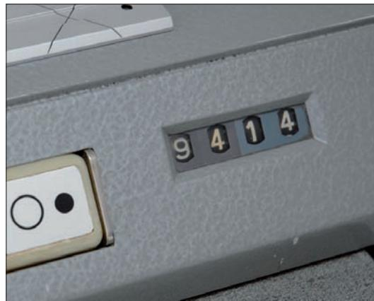
Das Zählwerk war eine Neuheit; es zeigt die Programmdauer nicht mehr in Metern, sondern erstmals in Minuten und Sekunden an. Bei 38,1 cm/s (15") ist die Programmdauer direkt ablesbar; bei 19,5 cm/s (7,5") ist die angezeigte Zeit mit zwei zu multiplizieren.
