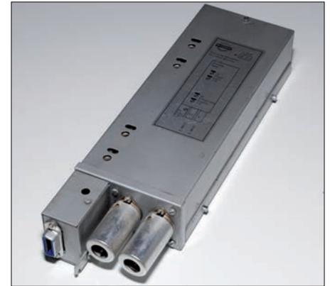
Der Aufnahmeverstärker ist so ausgelegt, dass eine Übersteuerungsreserve von ca. 15 db am Ausgang vorhanden ist. Diese ermöglicht auch die Verwendung von sogenannten High-Output-Bändern (z.B. Quantegy GP9). Über Aussteuerungsfragen und den notwendigen Kompromiss zwischen Klirrfaktor und Geräuschspannung bin ich bereits beim Punkt «Einstellung und Messung» genauer eingegangen.
