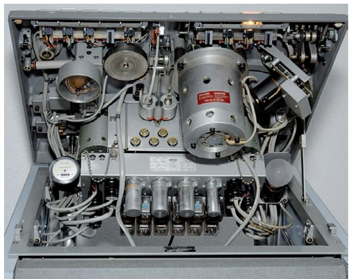
Die äusserst geringen Tonhöhenchwankungen der Studer C37 wurden durch eine Anzahl konstruktiver Massnahmen im Bandantrieb erreicht. Durch die kleine Entfernung zwischen der Vorberuhigungs-Schwungmasse und den Tonköpfen einerseits, sowie diesen und den Bandantriebs-
